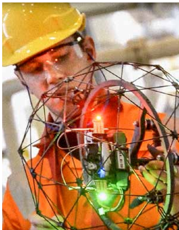
Inspectiedrones met een balconstructie worden gebruikt bij inspecties van industriële installaties.
