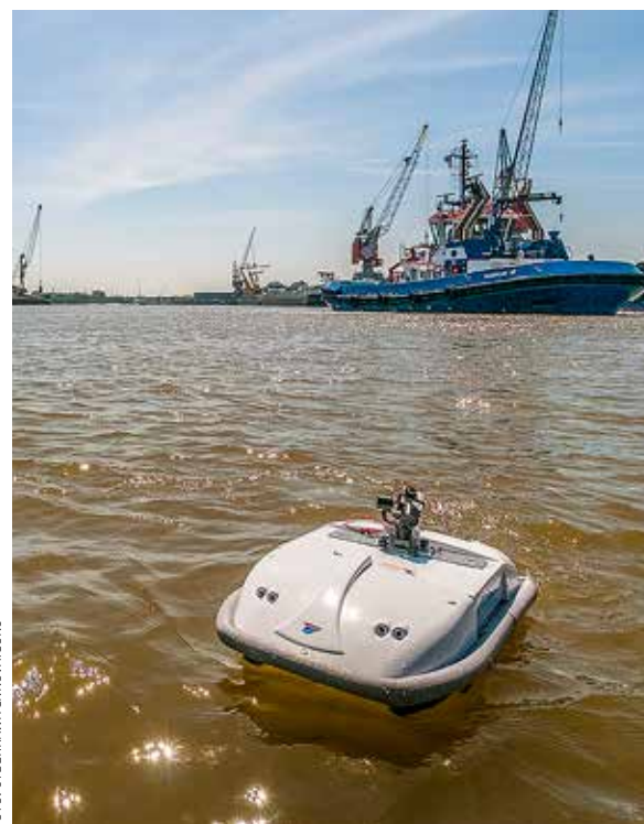
De varende drone van Aqua Smart XL heeft een camera voor inspecties vanaf het water.
