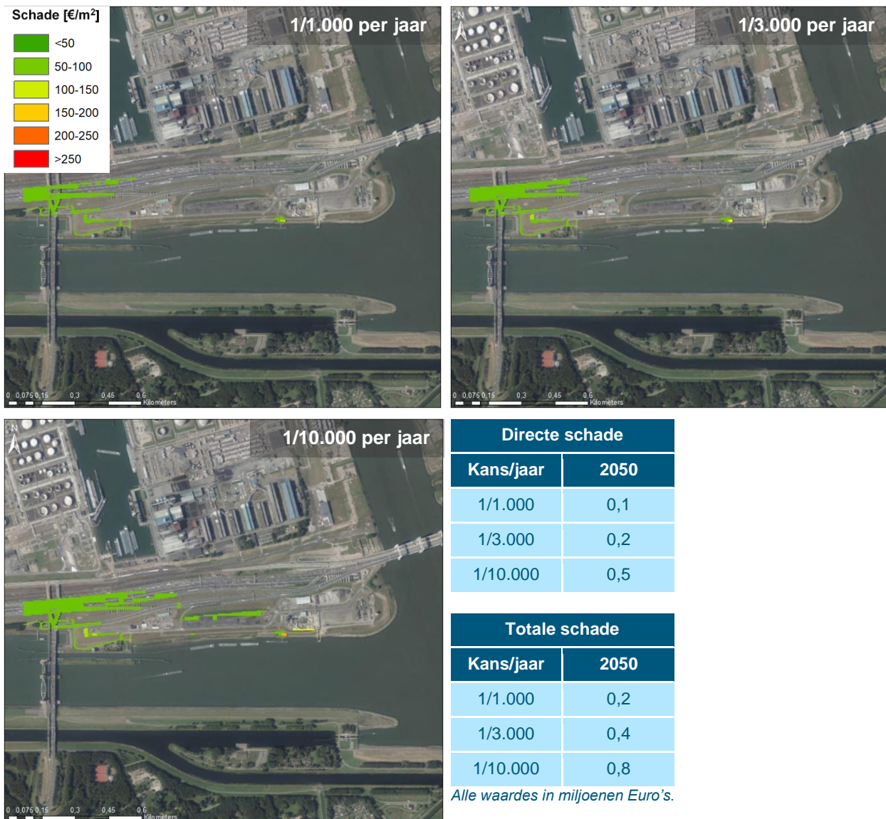
Figuur 8-6: Schade in het havengebied in de Botlek aan het Hartelkanaal in 2050 (W+ scenario) bij een kans van 1/1.000, 1/3.000 en 1/10.000
