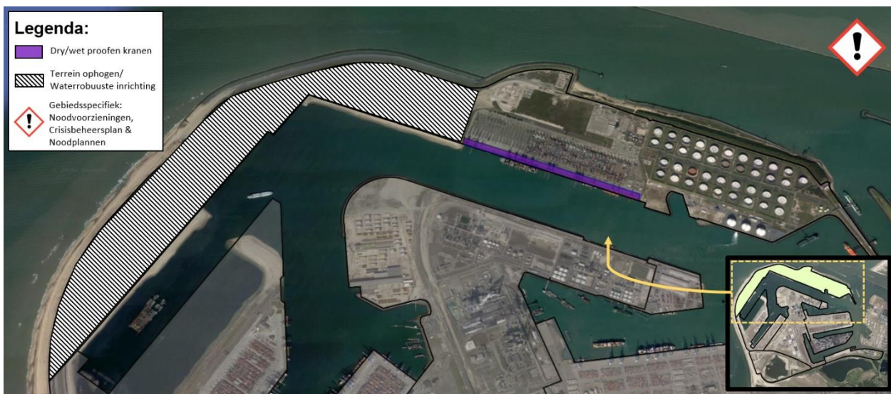
Figuur 5-2. Detail van de voorgestelde maatregelen in deelgebied 1, voor bescherming tot het scenario 1/1.000 bij zichtjaar 2050
