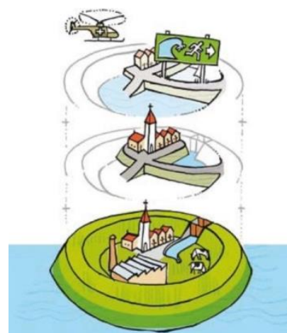
Figuur 16. MLV met van onder naar boven preventie, ruimtelijke adaptatie en crisisbeheersing.
