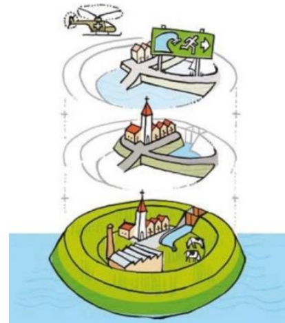
Figuur 12. MLV met van onder naar boven preventie, ruimtelijke adaptatie en crisisbeheersing.
